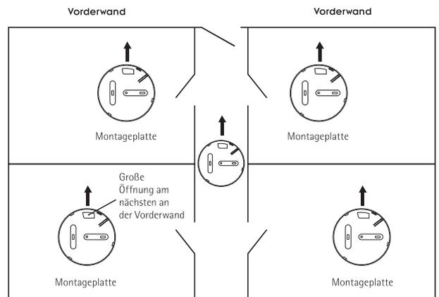
Richten Sie für eine optimale Funktion der Antennen alle Montageplatten in der gleichen Richtung aus.
