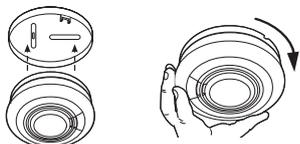
Durch Drehen des Geräts auf den Sockel wird die Batterie automatisch aktiviert.
